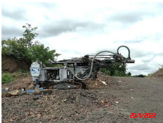
รูปที่ 3 เครื่องเจาะระเบิด
